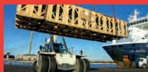
Le Palabora de Combi Lift a chargé, du 3 au 5 février, au F12 (Barra SNM) les éléments d'une centrale électrique Mitsubishi à destination de San Diego aux USA. Ce chargement de 1400 tonnes comprenait 250 colis (dont une turbine à gaz, un générateur de 295 tonnes, un rotor de 50 tonnes...). Une fois assemblées, les pièces formeront une centrale destinée à fournir l'électricité à une ville de 500 000 à 700 000 habitants ■
