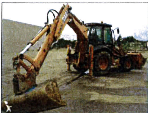
Exemple d'utilisation d'une pelle en rétro avec godet de curage plat
